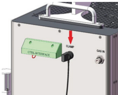
Ilustración de la conexión CLAMP
